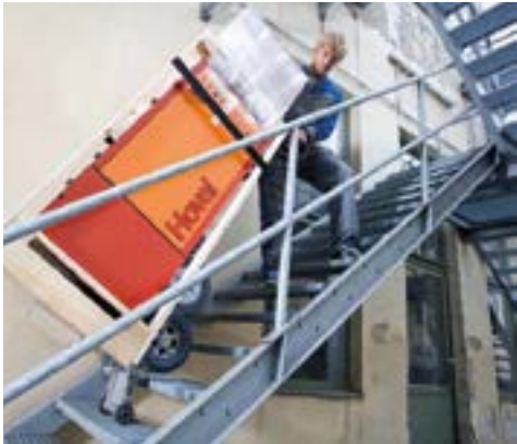
Bras motorisé assurant l'élévation
