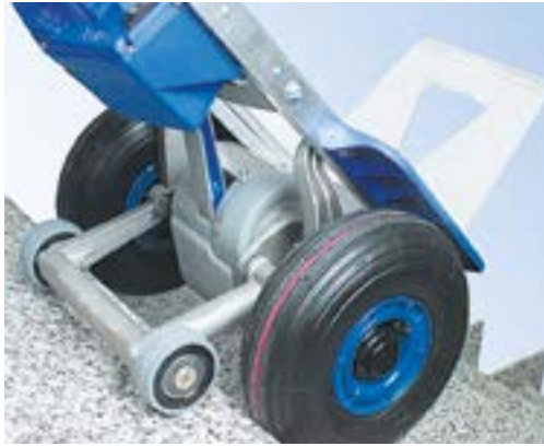
Bras motorisé assurant l'élévation
