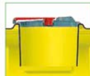
Trou d'homme avec couvercle monté sur charnière et manchette anti-vagues.
