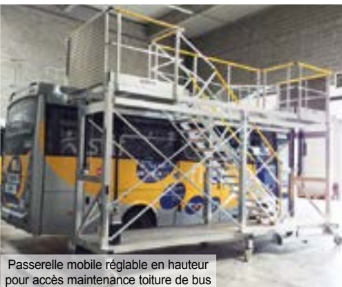
Structure échafaudage 2 x 72 m pour maintenance
