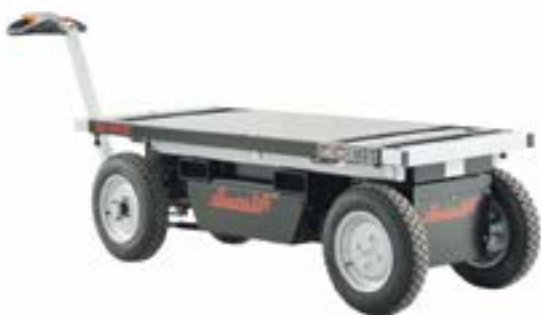
ST 1300 TROLLEY Poids : 450 kg Charge maximum : 1 300 kg Très compact : 700 mm de large
