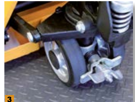
3 Frein à pied pour le blocage des roues
